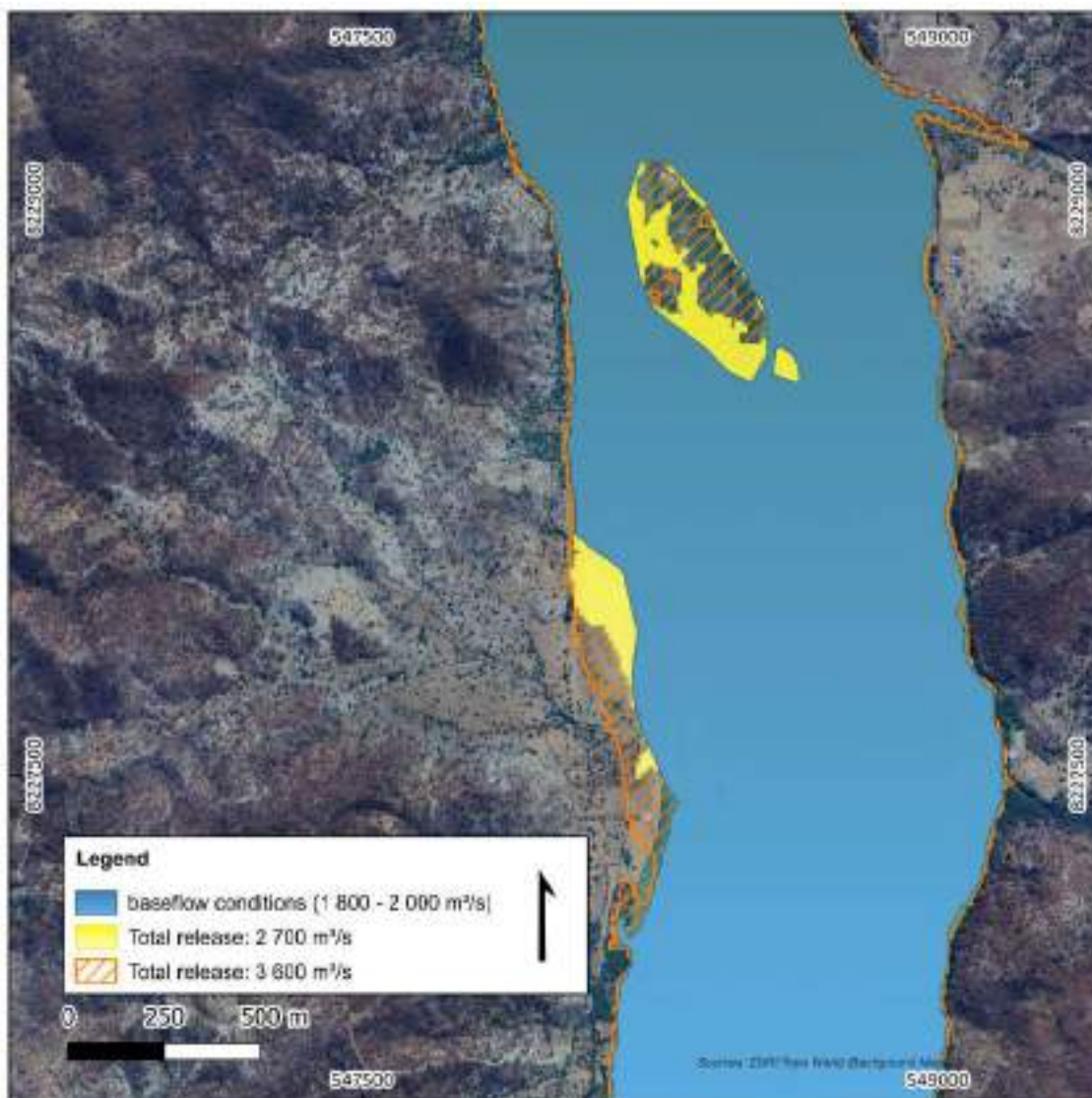
Figura 4-5. Impactos da subida do nível da água no local proposto para a barragem de Boroma. Os caudais mapeados são: 2.700 m³/s - adição de uma turbina da CBN com o sistema da CBS em pleno funcionamento e 3.600 m³/s - adição de três turbinas da CBN com o sistema da CBS em pleno funcionamento.
