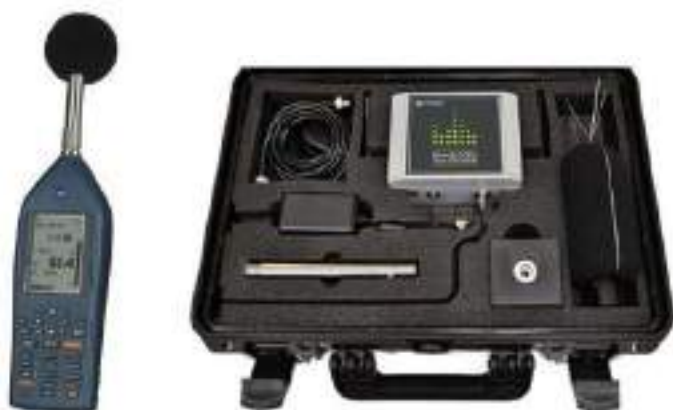
Figura 1. Foto do medidor dos níveis sonoros Norsonic 140 para medição a curta duração (à direita) e do Sistema de monitorização de ruído de longa duração Sonitus EM2030 (à esquerda).
