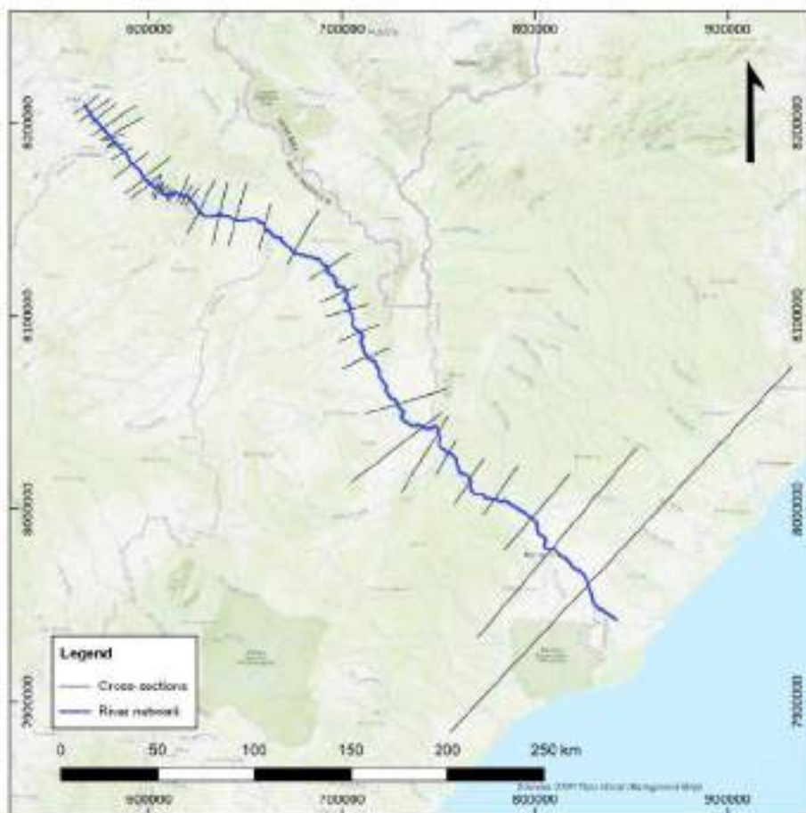
Figura 4-8. Vista da configuração do modelo hidráulico a jusante de Tete.
