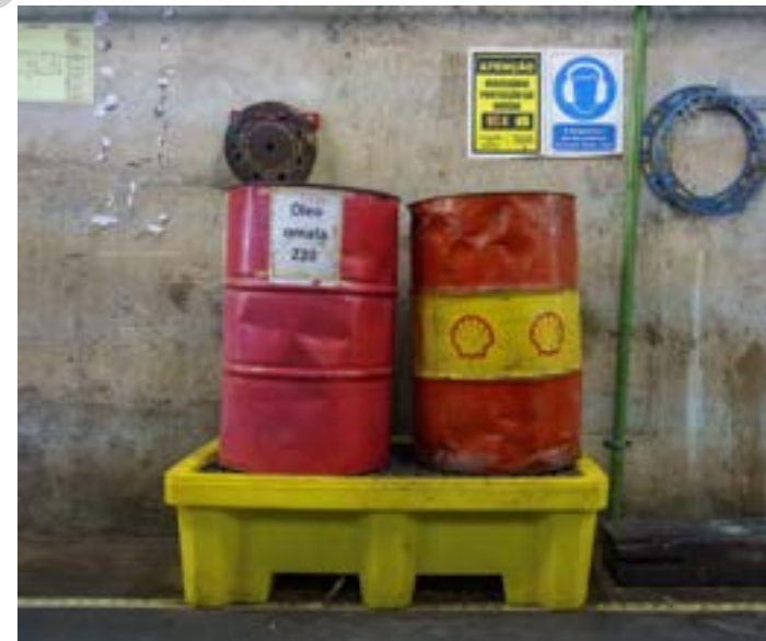
10. Tambores para óleo acondicionados sobre paletes de contenção
